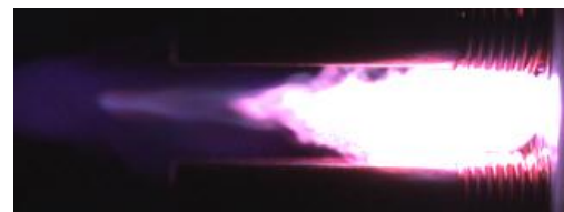
Рисунок 2. Модификация 2 комбинированного разрядника: формирование направленного плазменного потока, распространяющейся вдоль предварительно ионизованного канала.
