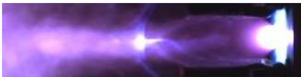
Рисунок 1. Модификация 1 комбинированного разрядника: формирование компрессионной зоны внутри плазменной струи.
