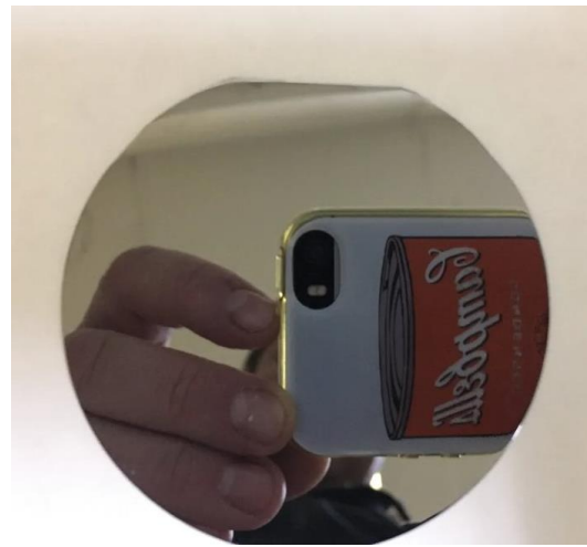
Кремниевая пластина для микросхем d=0.35\text{мм}
