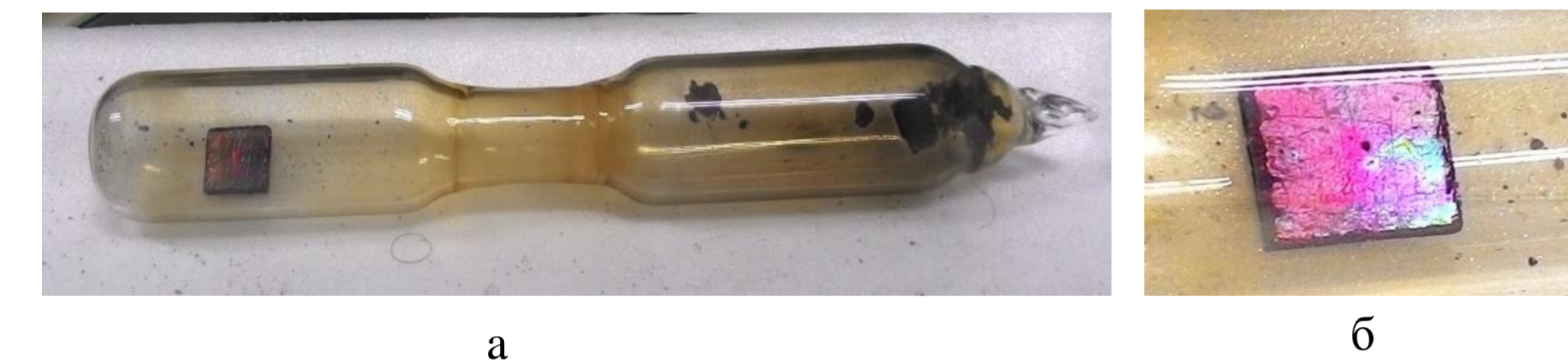
Рис. 2. Фотографии с результатом двухзонной интеркаляции высокоориентированного графита. а - реактор для интеркаляции, в левой части которого размещен образец графита, а в правой – навеска калия. б – поверхность графита после интеркаляции.
