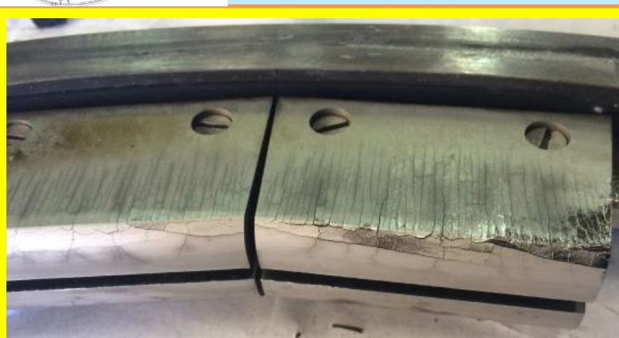
Токамак Т-10, ~1000 разрядов, 1MW ЭЦРН: W ITER grade лимитер - растрескивание и оплавление
