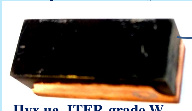
Пух на ITER-grade W после плазмы в ПЛМ
