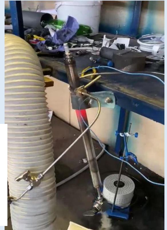
Проточный реактор бескислородного горения ацетилена. М.С. Власкин (ОИВТ), Ноябрь 2020
